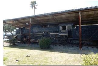
公園内のステージの柱や展示物の SL 蒸気機関車に、錆びつきや剥がれ等が多数発生しています。また、遊具の階段にも剥がれが発生しています。
