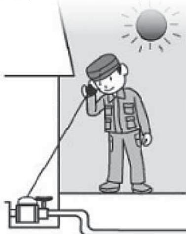
限りある資源（水）を有効に利用するために、漏水防止対策として行っています。漏水調査の方法は、道路内の配水管や止水栓・水道メーターの音を調査機器を使い調査し、漏水の有無を判断します。
